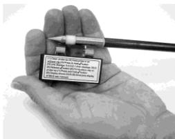
4. Прикоснитесь наконечником датчика к зажиму калибровки как изображено на картинке выше. Нажмите кнопку калибровки и удерживайте её в нажатом состоянии. Прибор выдаст на дисплей результат 24.8%, который означает завершение процесса, т.е. заводская калибровка установлена. **\*\*Если прибор выдаёт на дисплей результат “99.9” , значит во время калибровки произошла ошибка. Попробуйте повторить процесс калибровки с самого начала.**
